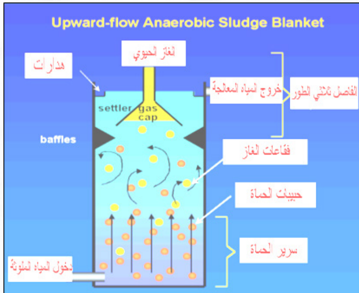
الشكل (1-3): مفاعل UASB
