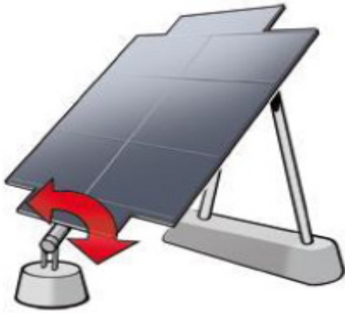
الشكل (3): متتبع المحور الواحد الأفقي
