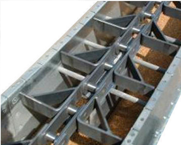
ومن جورة الاستقبال من خلال فتحات يتم نزول القمح إلى ناقل سلسلي والتي يشكل الشرايين والأوردة داخل جسم الصوامع. توضح الصور التالية الناقل السلسلي:
